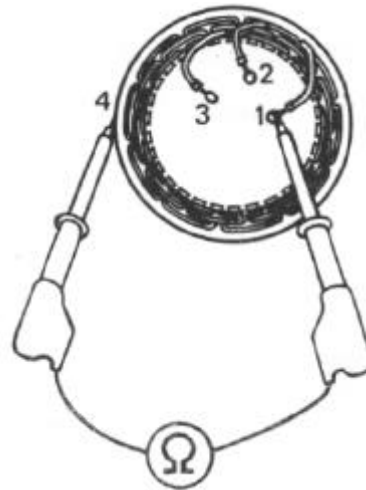
Bild E 20. Stator überprüfen
